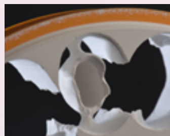
Poškozená náhrada při vyjmutí z frézky.
