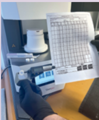
Kalibrace pece pomocí PTC kroužku, digitálního měřidla a teplotní tabulky.
